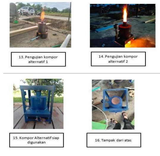
Gambar 1. Pembuatan Kompor Bahan Bakar Oli Bekas Tanpa Blower
