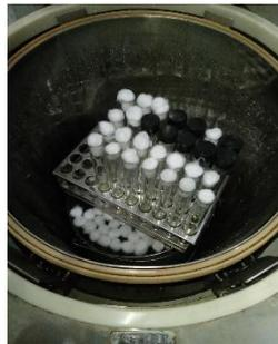
Sterilisasi menggunakan autoklaf suhu 121°C selama 15 menit dan SOP laboratorium
