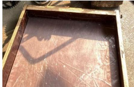
**Gambar 6.** Cetakan Tanpa Lubang
