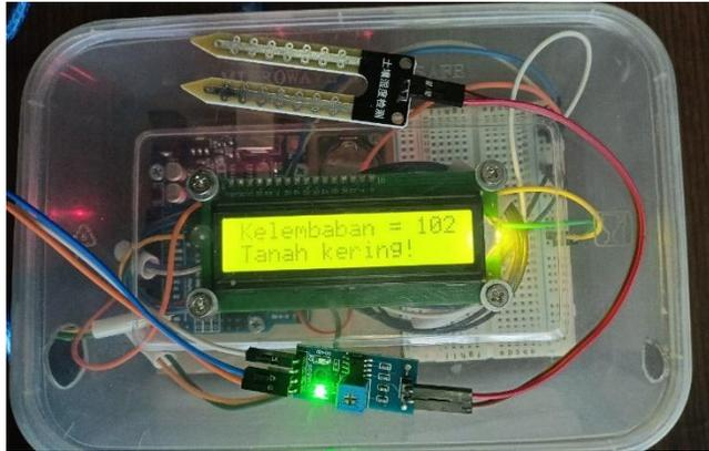
**Gambar 6** Kondisi Sensor Tanah dalam keadaan kering berjalan
