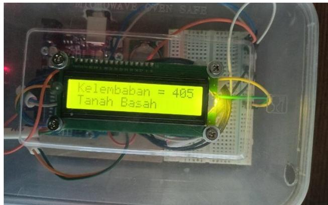
**Gambar 7** Kondisi Sensor Tanah dalam keadaan basah berjalan
