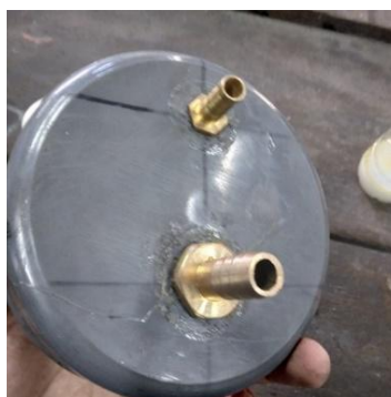
Gambar 11. Penutup Shell Setelah Pemasangan Komponen
