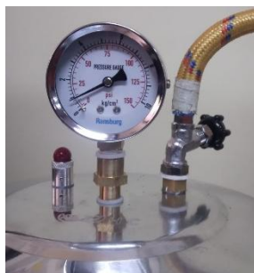
Gambar 8. Tutup Pressure Cooker Setelah Modifikasi
