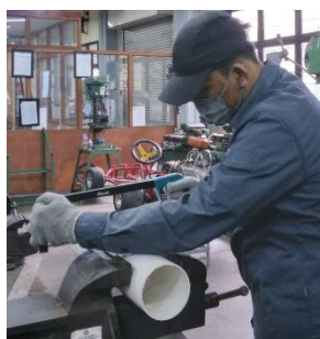
Gambar 9. Proses Pemotongan Pipa Shell Kondensor
