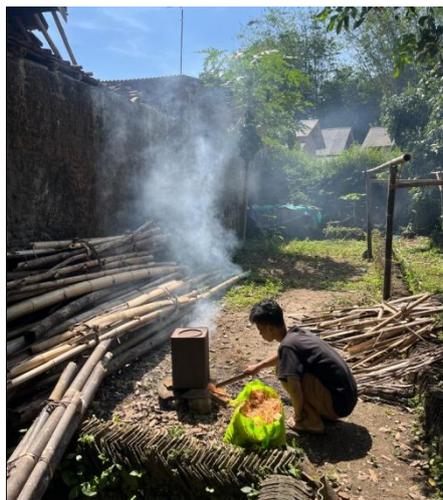
**Gambar 1. Proses *Trial* Pembuatan Biochar dengan Teknik Retort Tertutup**
