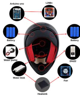
Gambar 3 Desain Rancang Bangun Sistem Pendingin Helm Tampak Dalam
