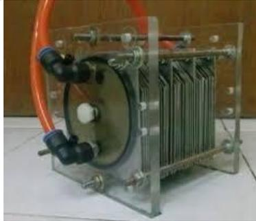
**Gambar 2.** Generator HHO dengan elektroda berbentuk susunan pelat
