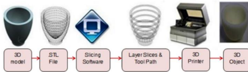
Gambar 2 Proses pencetakan 3D dari desain hingga pencetakan
