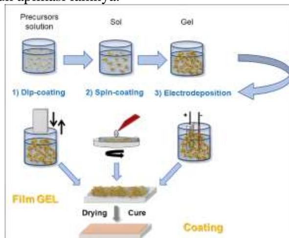
Gambar 3.1 Proses pembuatan nano coating
